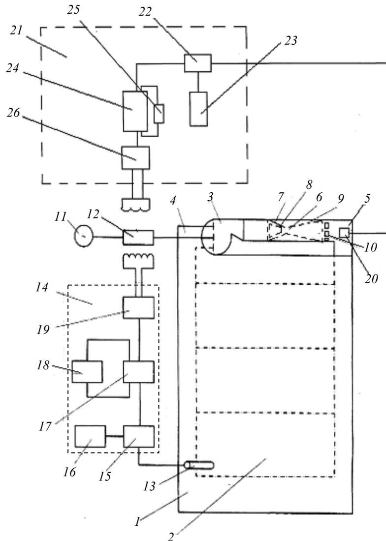
Термокамера для испытания электронных изделий [2] состоит из кожуха 1, в котором размещены рабочая камера 2, где между вытяжным 4 и нагнетательным 5 патрубками установлен вентилятор 3, узел очистки рециркуляционного воздуха 6, установленный в нагнетательном патрубке и выполненный в виде соосно соединенных суживающегося диффузора 7
