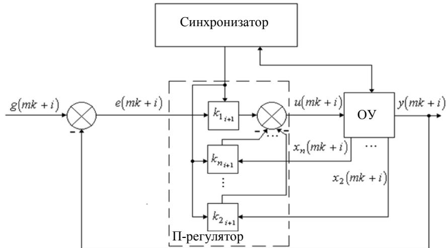
Метод синтеза матрицы ЛОС  $K_{i+1}$ ,  $i = \overline{0, (k-1)}$ , с использованием метода локальной оптимизации, гарантирующего расположение корней характеристического полинома замкнутой системы в желаемой области, можно рассматривать как метод синтеза модальных управлений, когда желаемые корни характеристического полинома должны быть расположены в некоторой области, а не заданы однозначно [6].
